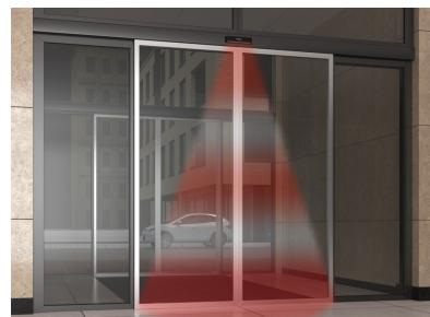
Датчик AD-34 — устройство комбинированного типа объединяет в одном корпусе микроволновый датчик-радар движения и инфракрасную шторку присутствия. Датчик может работать как вместо, так и вместе с парой фотозлементов безопасности при установке в составе автоматической раздвижной двери с приводом AD-SP.
