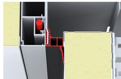
Уникальная система обогрева контура направляющих, предотвращающая образование конденсата и наледи, устанавливается при эксплуатации ворот в зоне раздела температурных сред.
