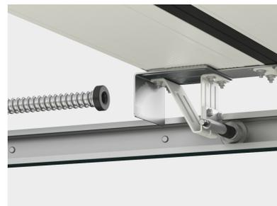
Площадка-упор устанавливается на верхнюю панель, увеличивая площадь сопряжения демпфера амортизатора и полотна ворот. Узел исключает возникновение аварийных ситуаций, вызванных неправильной установкой и регулировкой амортизаторов монтажными бригадами.
