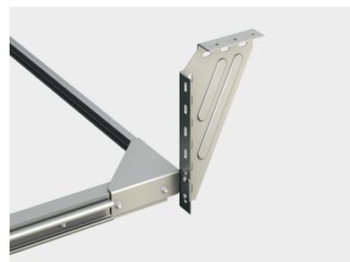
Кронштейн крепления С-профиля к направляющей повышает жесткость направляющих, позволяет выдержать прямые углы в системе горизонтальных направляющих, дает возможность регулировки угла наклона кронштейна крепления горизонтальных направляющих к потолку, исключает ошибки при монтаже.
