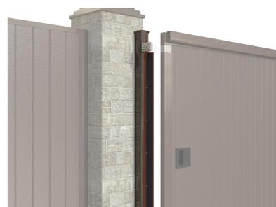
Нащельник закрывает зазор между полотном и столбом-ловителем. Изделие состоит из щетки ПВХ с увеличенным ворсом длиной 70 мм. Основанием щетки служит алюминиевый профиль, окрашенный в цвет окантовки ворот.
