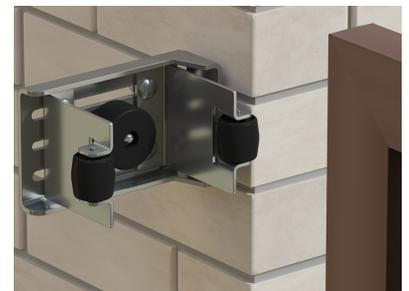
Новый верхний ловитель (опция) обеспечивает бесшумное закрытие ворот. Прорезиненные ролики защищают лакокрасочное покрытие ворот от повреждений. Регулируемые лепестки ловителя позволяют устанавливать изделие на ворота с толщиной щита от 51 до 154 мм.
