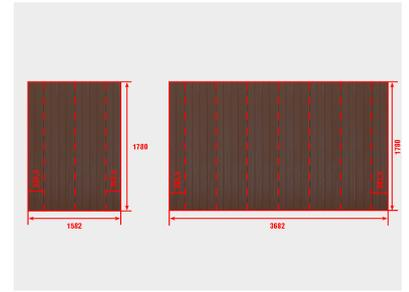
Продольная резка панели в основной части полотна и в противовесе. Клепочное соединение приходится на основную поверхность панели, что исключает прогиб П-профиля.
