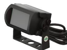
Артикул «147-3750». РА — универсальный радар для управления промышленными воротами и другими устройствами. Корпус радара выполнен из алюминиевого сплава. Имеет двойной диапазон обнаружения. Настройка через мобильное приложение. Высота обнаружения — от 2 до 6 м (стандарт); 10 м (X). Регулировка угла — от 0 до 90° в продольном направлении.
