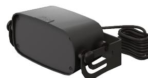
Артикул «147-3751». PRO BT — радар с распознаванием людей и транспортных средств, использующийся для управления промышленными воротами и другими устройствами. Может различать транспортные средства и пешеходов, определять продольное и поперечное движение. Настройка через мобильное приложение. Высота обнаружения — от 3 до 7 м. Регулировка угла — от 0 до 180° в продольном направлении.
