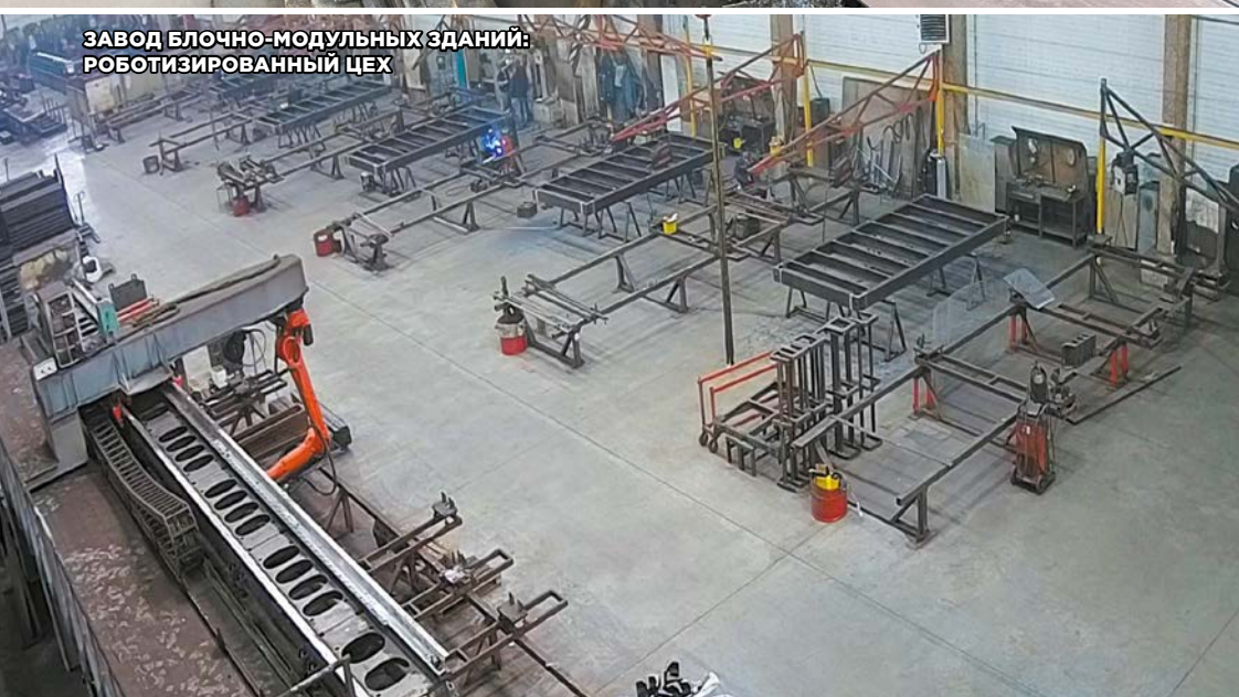
ЗАВОД ПОЛНОКОМПЛЕКТНЫХ ЗДАНИЙ: АВТОМАТИЧЕСКИЙ КОМПЛЕКС ДЛЯ СВАРКИ БАЛКИ
