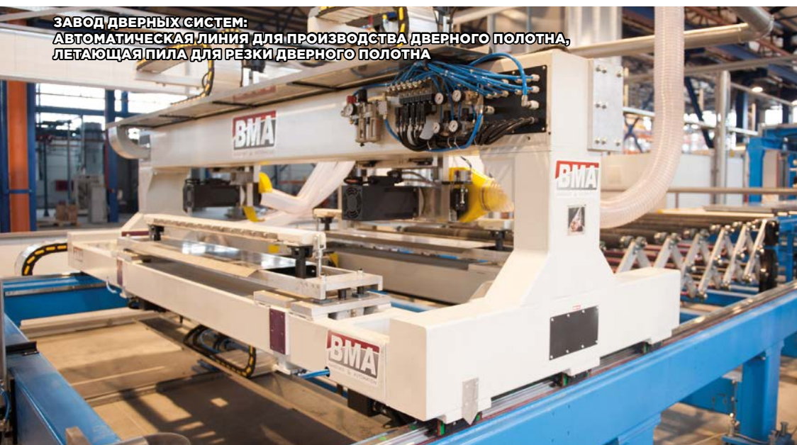
ЗАВОД ДВЕРНЫХ СИСТЕМ: АВТОМАТИЧЕСКАЯ ЛИНИЯ ДЛЯ ОБРАБОТКИ ДВЕРНЫХ ПАНЕЛЕЙ
