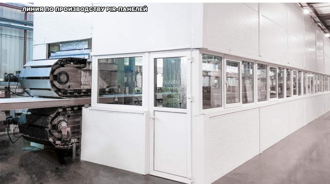
ЦЕХ ПРОИЗВОДСТВА PIR-ПАНЕЛЕЙ: УЧАСТОК СМЕШЕНИЯ И ЗАЛИВКИ PIR-КОМПОНЕНТОВ
