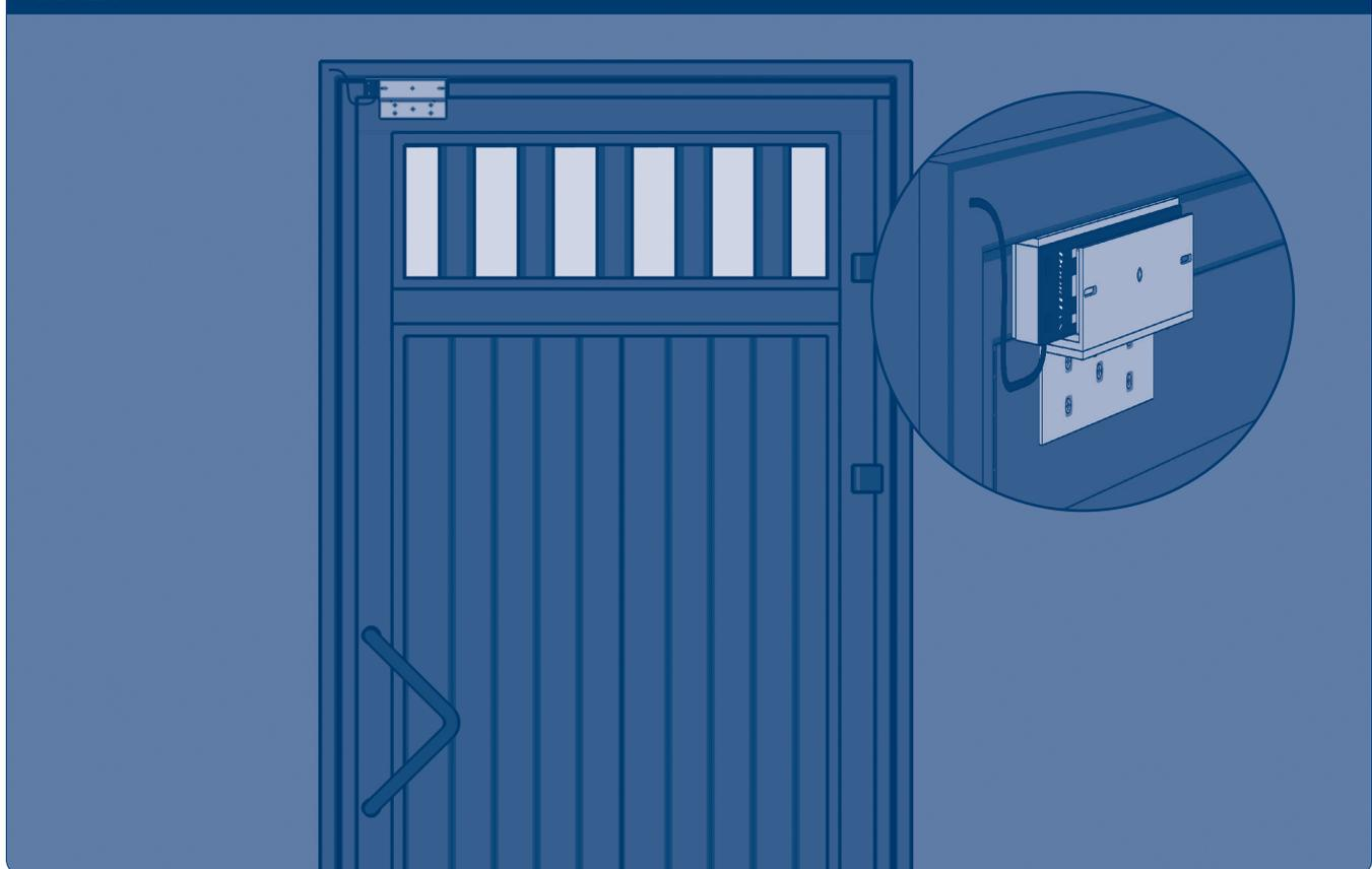
Монтаж на распашные калитки производится аналогично монтажу на распашные ворота. На раму калитки устанавливается кронштейн электромагнитного замка, к которому крепится сам замок. Соответственно, два
