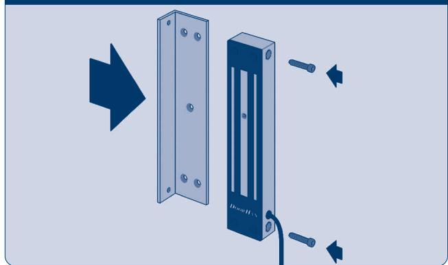
Рис. 3.3. Г-образные пластины крепления якоря
