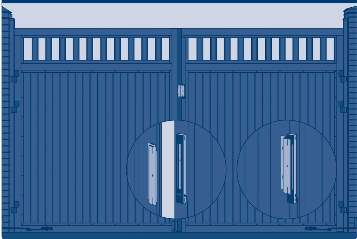
Для обеспечения правильной работы замка рабочие поверхности якорной пластины и корпусной части должны прилегать друг к другу при закрытых створ-
