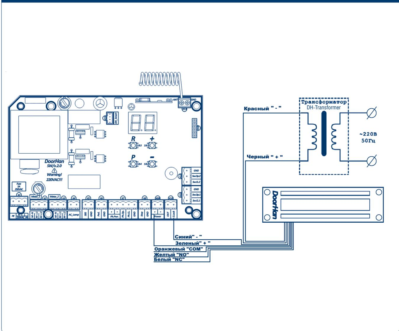
Рис. 4.2. Схема подключения замка к блоку управления CV01
