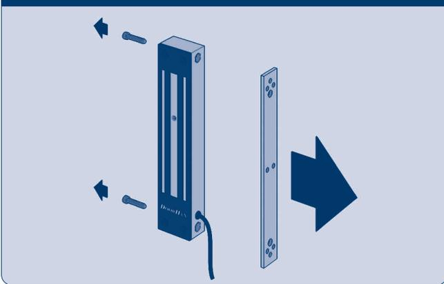
Рис. 3.2. Установка Г-образной пластины крепления на электромагнит
