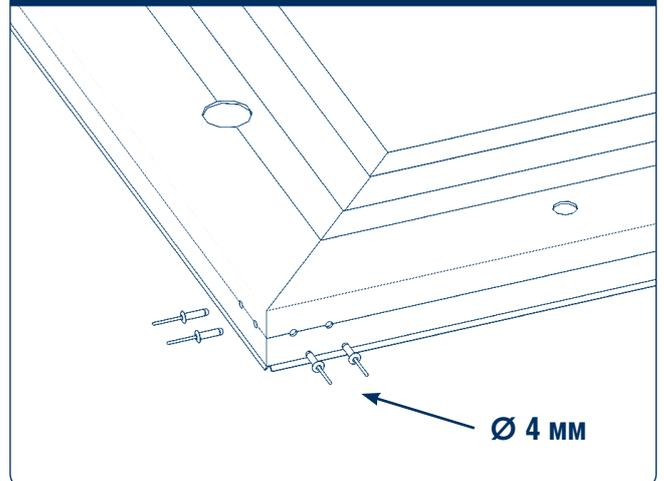
Заклепками  $\text{Ø } 4,0 \text{ мм}$  скрепите вертикальные и горизонтальный профили рамы. Обеспечьте наиболее плотное прилегание профиля друг к другу.
