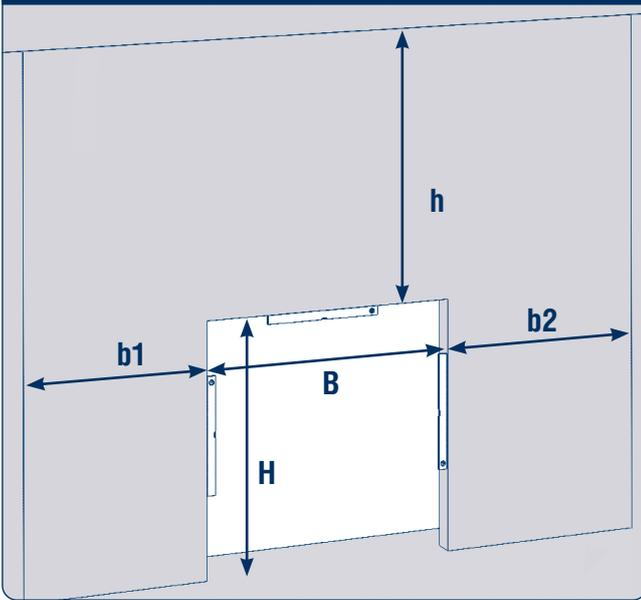
**h** — высота проема (расстояние от пола до верха проема)  $\pm 3$  мм.
