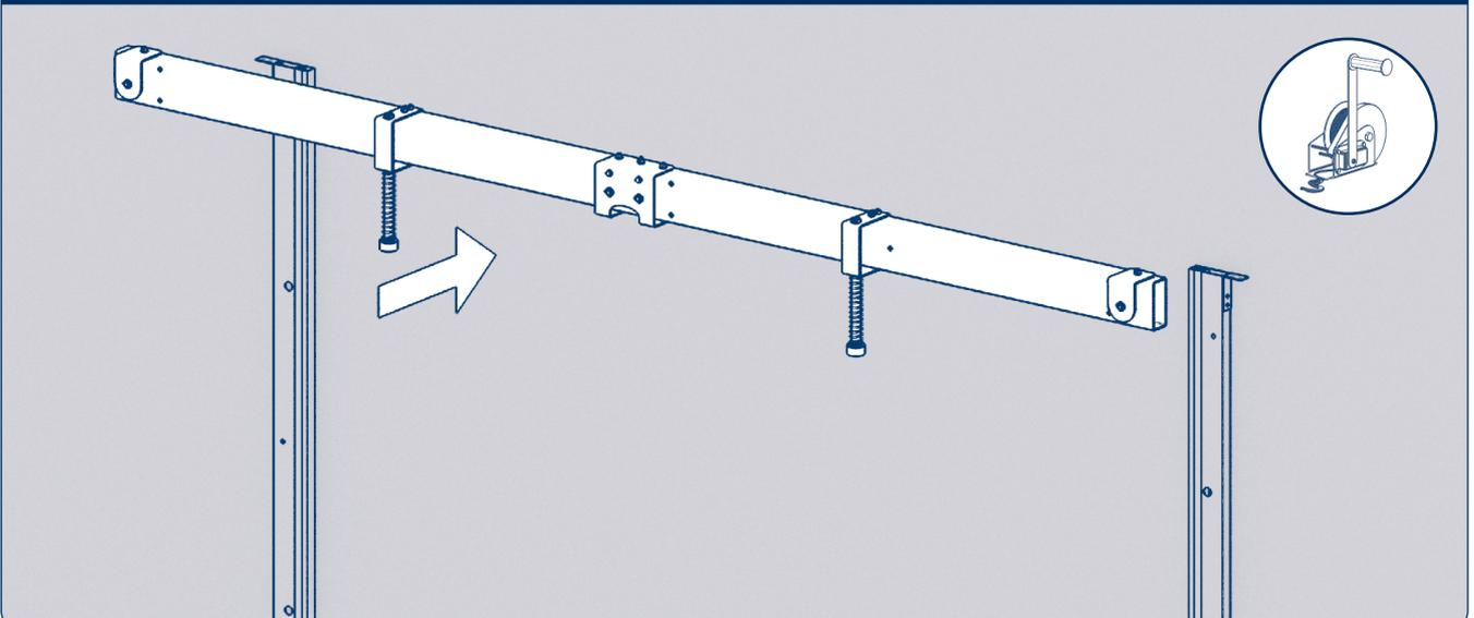
Поднимите несущую балку при помощи лебедки и предварительно установите ее на проем.
