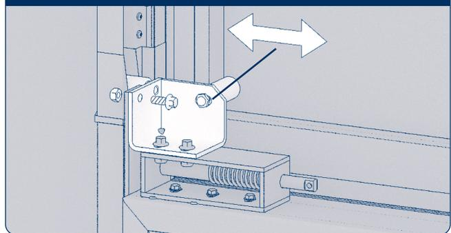
Закрепите болтами  $M8 \times 30$  мм верхнюю роликовую опору к пластине роликовой опоры. Отрегулируйте зазор между роликом и направляющими.
