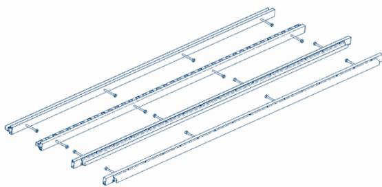
Четыре вертикальные направляющие, закрепленные на алюминиевом профиле, с установленными болтами для крепления к стене.
