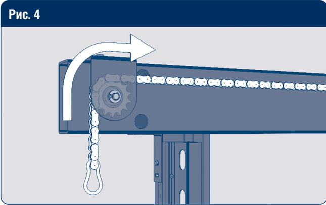
Установите цепь, заведя ее в кронштейн крепления боковой звездочки, установленный на несущей балке.
