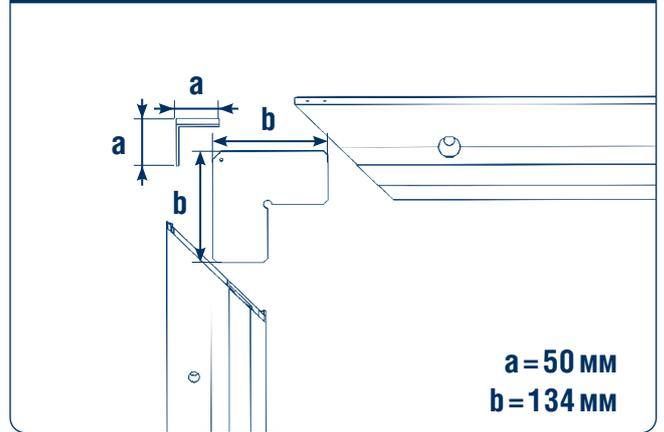
Установите алюминиевые сухари (50×50 мм) и стальные позиционные уголки (134×134 мм) в профили рамы и соедините все элементы между собой.
