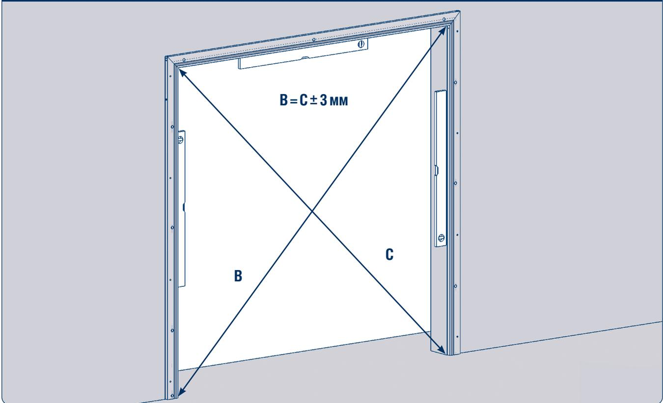
Зафиксируйте раму в проеме. Проверьте вертикальность и горизонтальность установки с помощью уровня; разность диагоналей должна составлять не более 3 мм.
