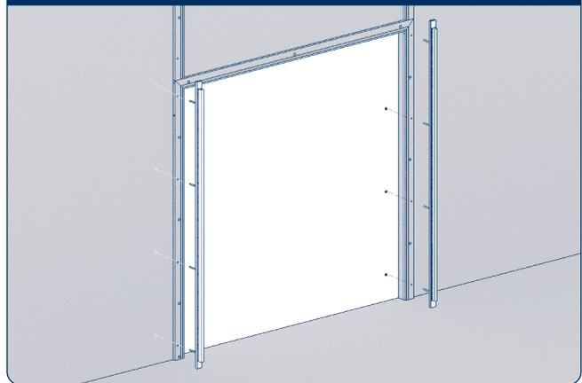
При установке на сэндвич-панель просверлите сквозные отверстия  $\varnothing 15$  мм (для пластиковых болтов).
