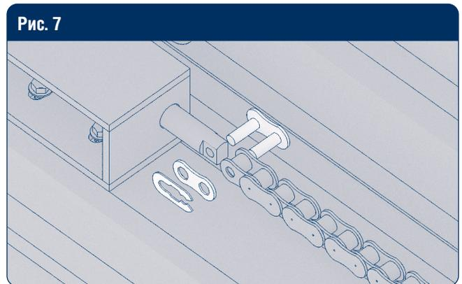
Закрепите край цепи к устройству защиты от падения полотна при помощи соединительного звена.
