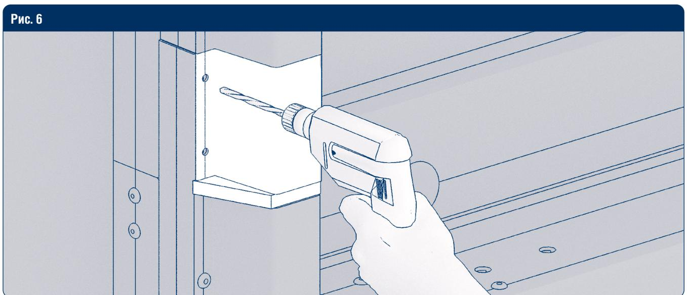
В месте стыка вертикальных направляющих просверлите два отверстия в раме сверлом  $\varnothing 4,2$  мм через держатель направляющей.
