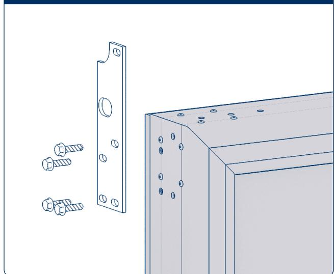
Установите пластину роликовой опоры на верх полотна двери, используя болты  $M8 \times 30$  мм.
