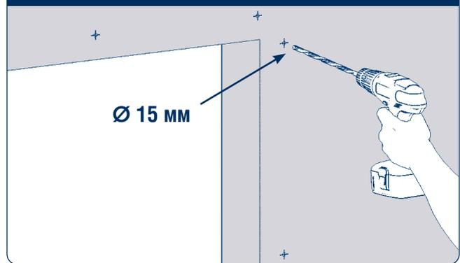
При установке на сэндвич-панель просверлите сквозные отверстия  $\varnothing 15$  мм (для пластиковых болтов).
