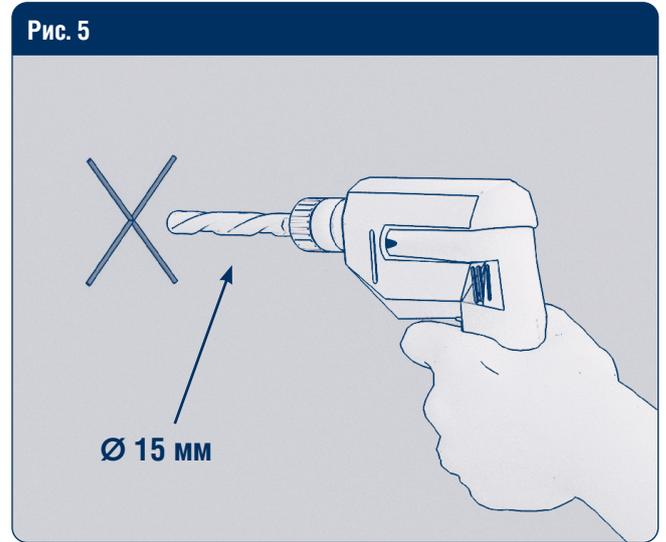
В случае установки двери на сэндвич-панель просверлите сквозные отверстия Ø15 мм (для применения пластиковых болтов).
