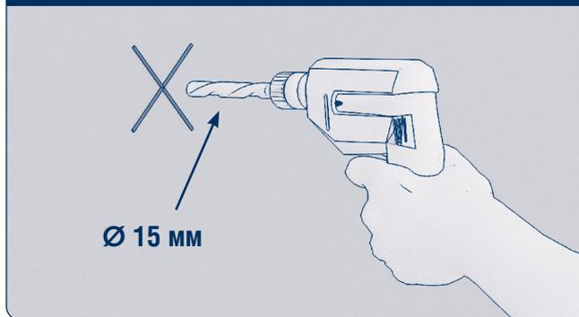
При установке на сэндвич-панель просверлите сквозные отверстия Ø 15 мм (для пластиковых болтов).
