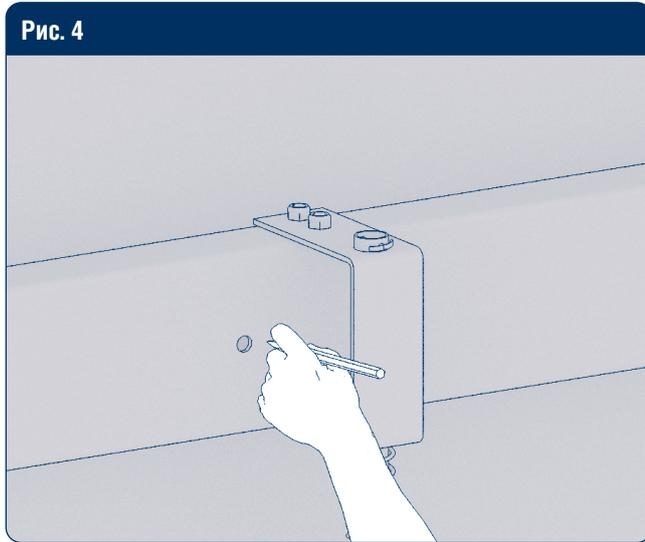
Через имеющиеся в балке отверстия сделайте разметку для крепления к проему.
