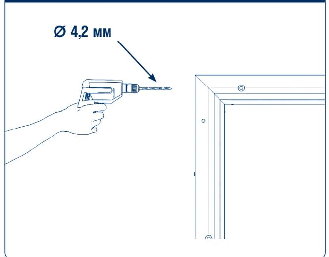
Через отверстия в раме просверлите сверлом  $\text{Ø } 4,2 \text{ мм}$  отверстия в алюминиевых сухарях (50 × 50 мм).
