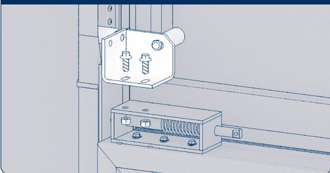
Закрепите верхнюю роликовую опору к устройству защиты от падения полотна болтами  $M8 \times 20$  мм.
