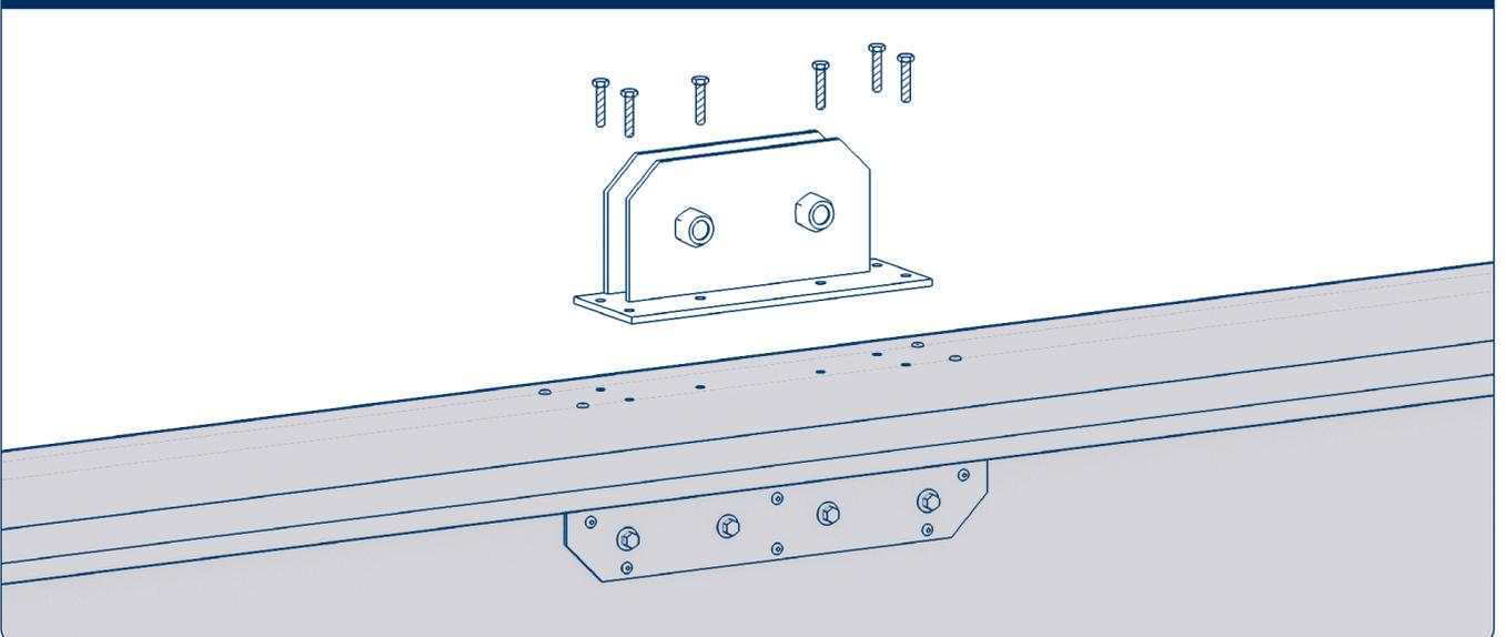
Установите сверху по центру полотна двери кронштейн цепи со звездочками, используя болты М8 × 30 мм.
