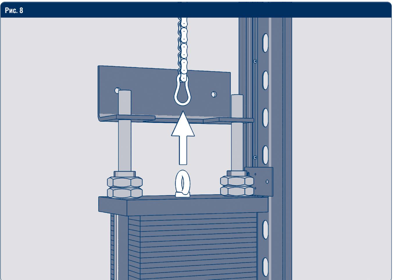
К противоположному краю цепи закрепите противовесы, используя для этого карабины.
