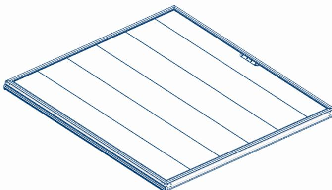
Полотно двери из сэндвич-панели в алюминиевом каркасе, боковой уплотнитель, нижний уплотнитель, комплект крышек рамного профиля. В случае обогрева полотно комплектуется обогревающим кабелем (см. п. 8.3, стр. 25).
