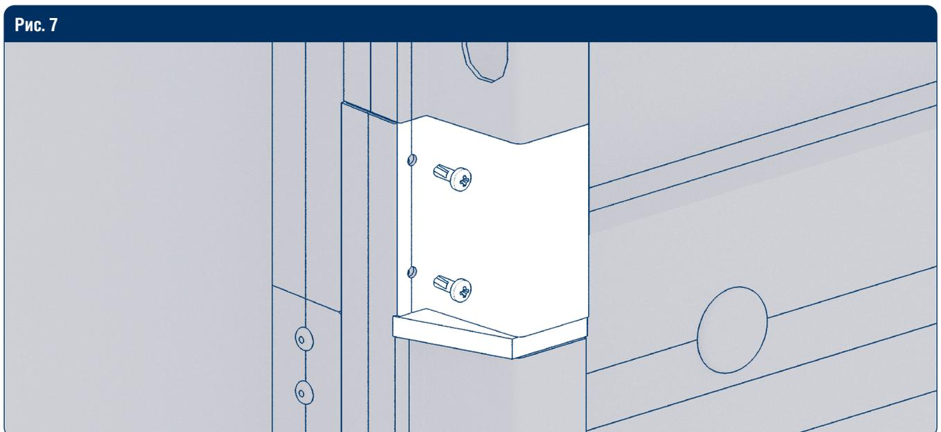
Используя саморезы  $4,2 \times 16$  мм со сверлом, закрепите держатель направляющей к раме двери.
