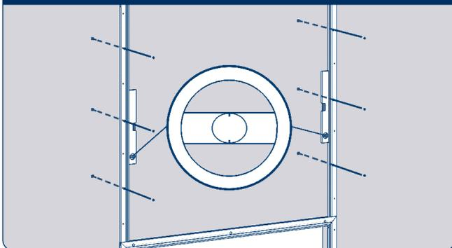
Закрепите раму, после чего проверьте уровень. Выбор крепежных элементов зависит от типа стены проема.
