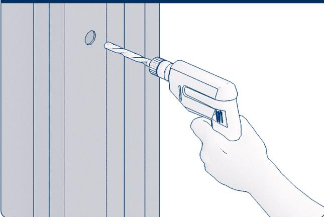
Установите нижние части направляющих на проем, предварительно выровняв их по уровню. По имеющимся отверстиям на раме просверлите отверстия для крепления вертикальных направляющих к проему, используя сверло  $\varnothing 15$  мм.
