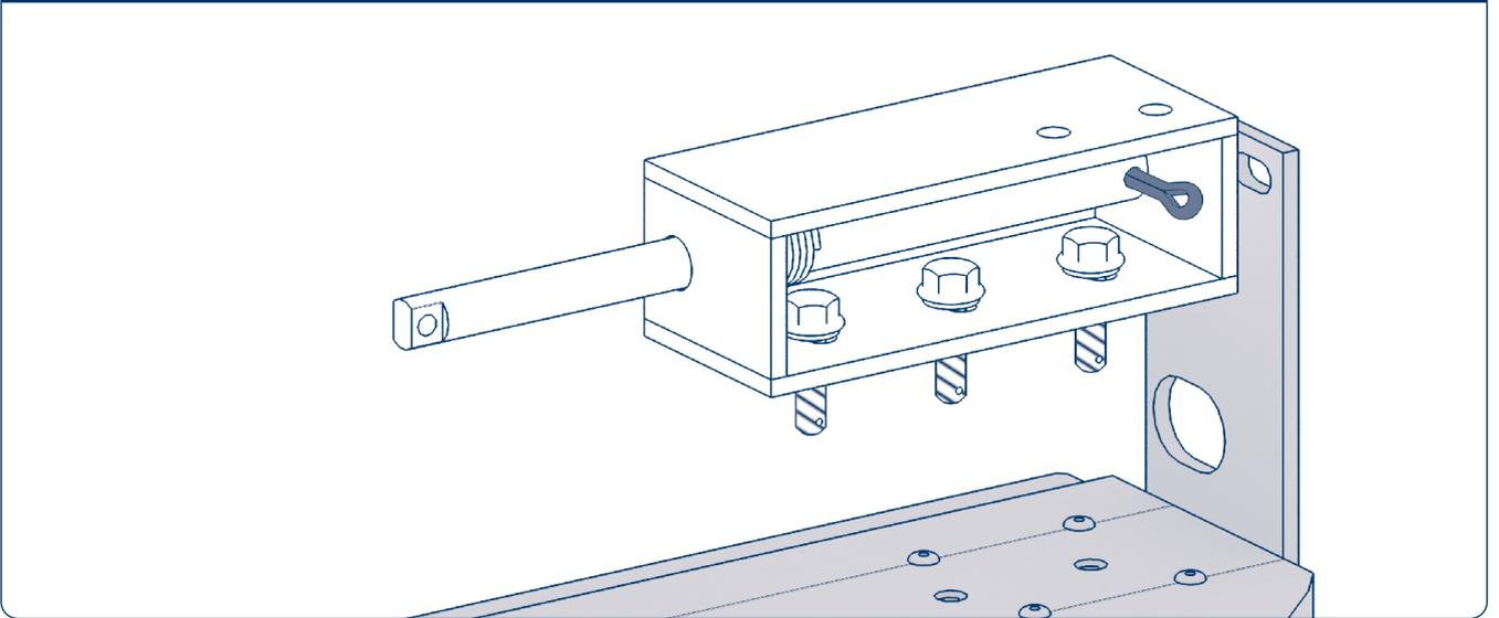
Установите устройства защиты от падения полотна на верх двери, используя болты М8 × 30 мм.
