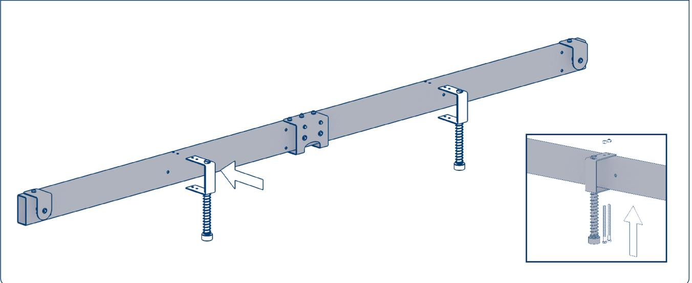
На несущую балку рамы установите амортизаторы, используя болты  $D=M12$  и  $L=170$  мм с гайками  $D=12$  мм.
