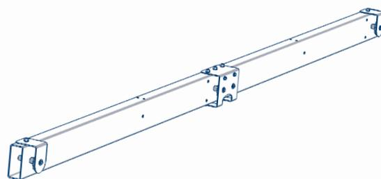
Стальная несущая балка с установленными кронштейнами крепления звездочек.
