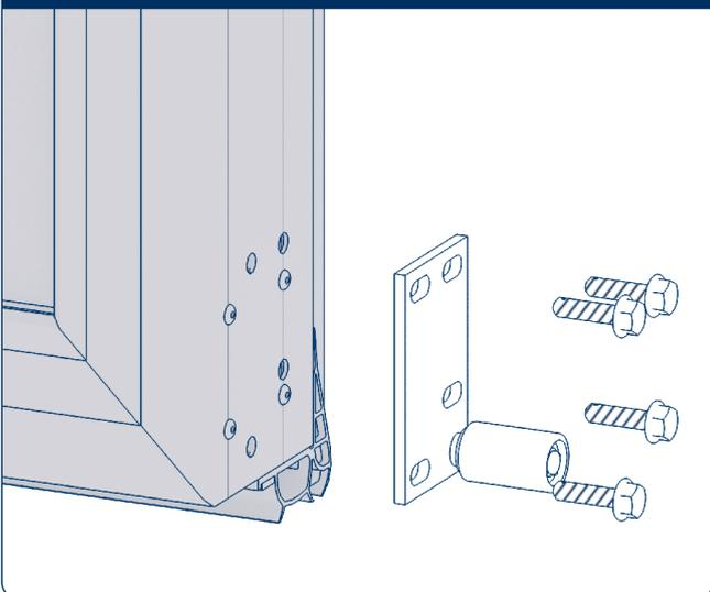
Установите нижние роликовые опоры на низ полотна двери, используя болты  $M8 \times 30$  мм.
