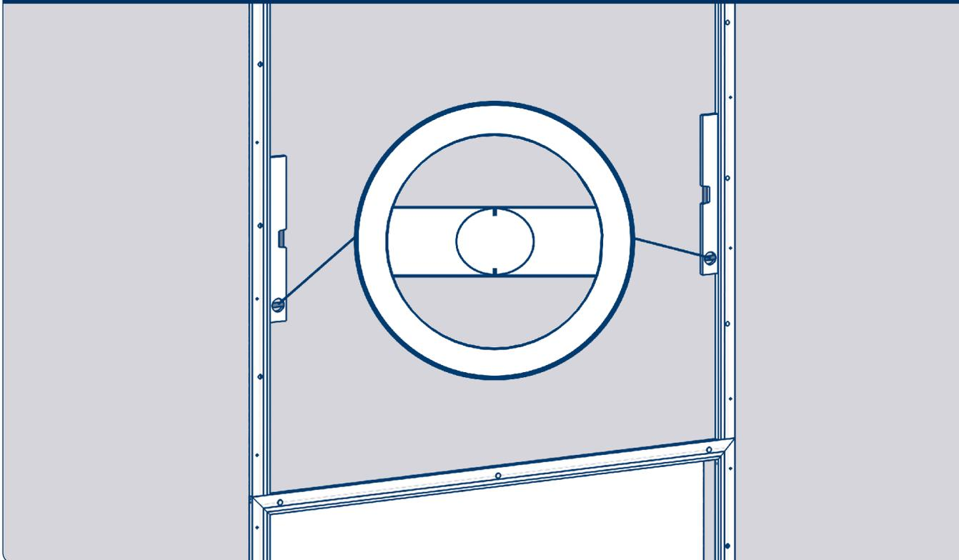
Установите профили-надставки рамы на проем, предварительно выровняв их по уровню. В случае применения системы обогрева контура рамы, перед монтажом, заведите питающий кабель в профиль-надставку (см. п. 8, стр. 22).
