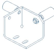
Рис. 11. Нижняя роликовая опора
