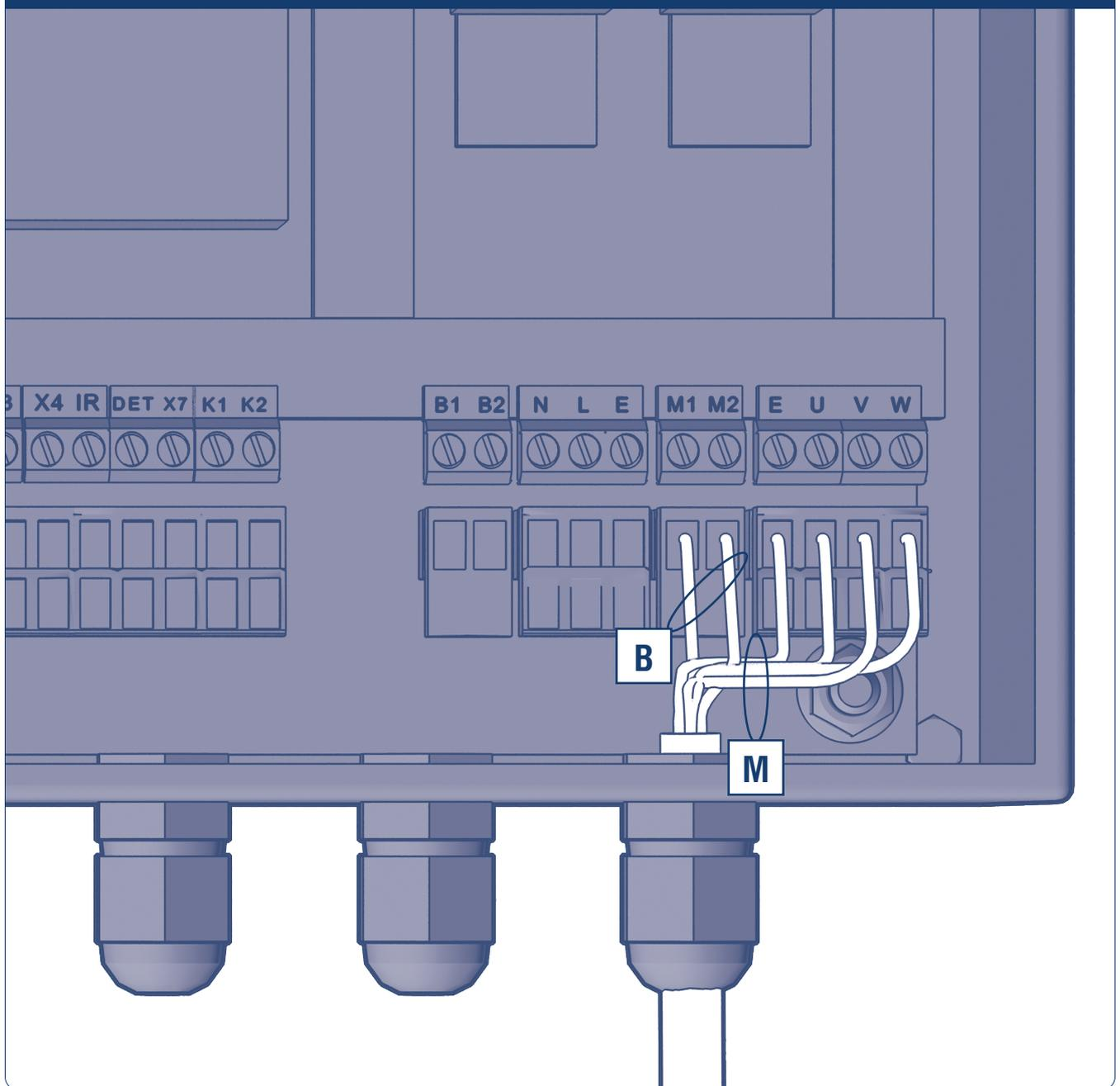
В — электромагнитный тормоз двигателя
