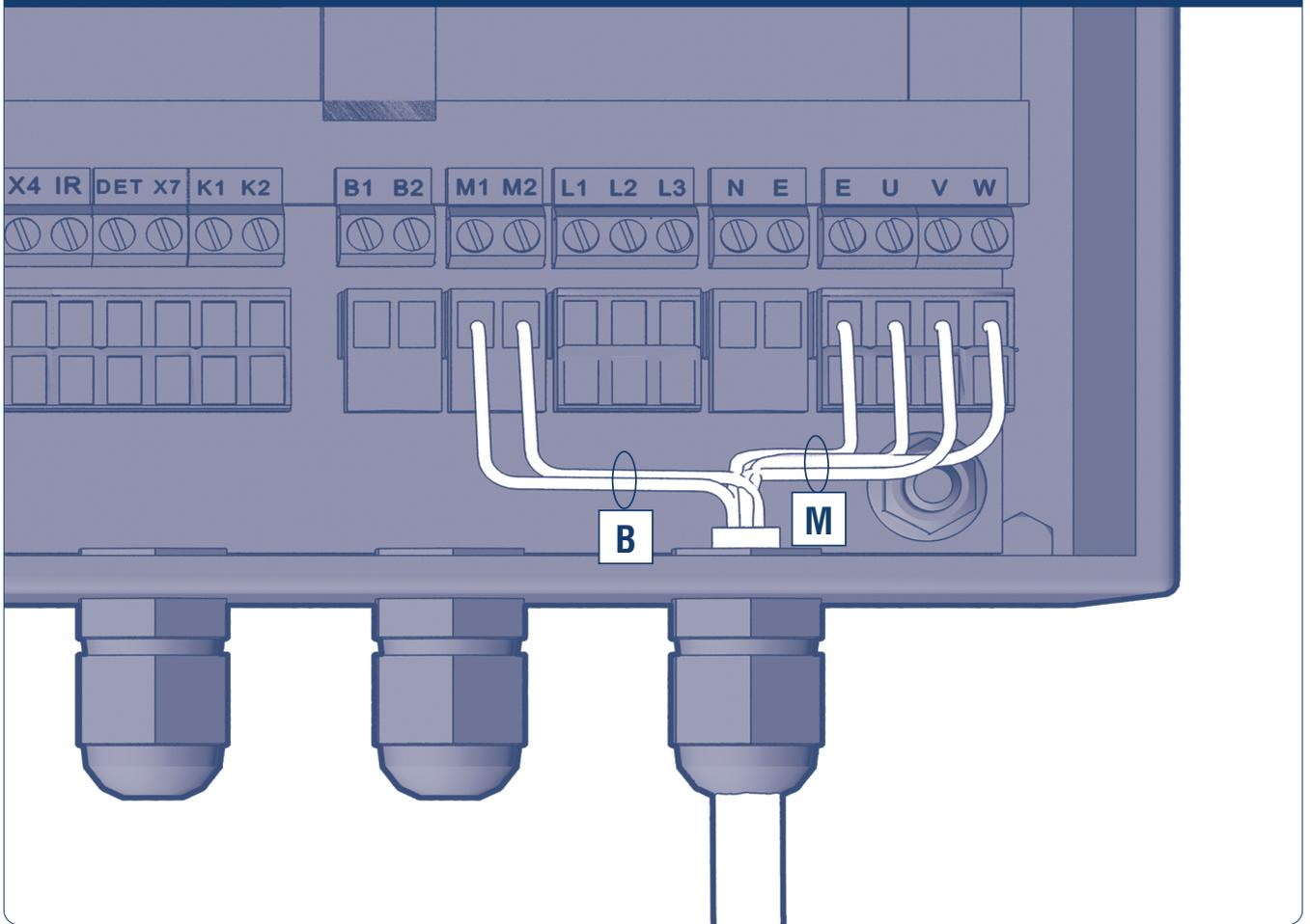
В — электромагнитный тормоз двигателя
