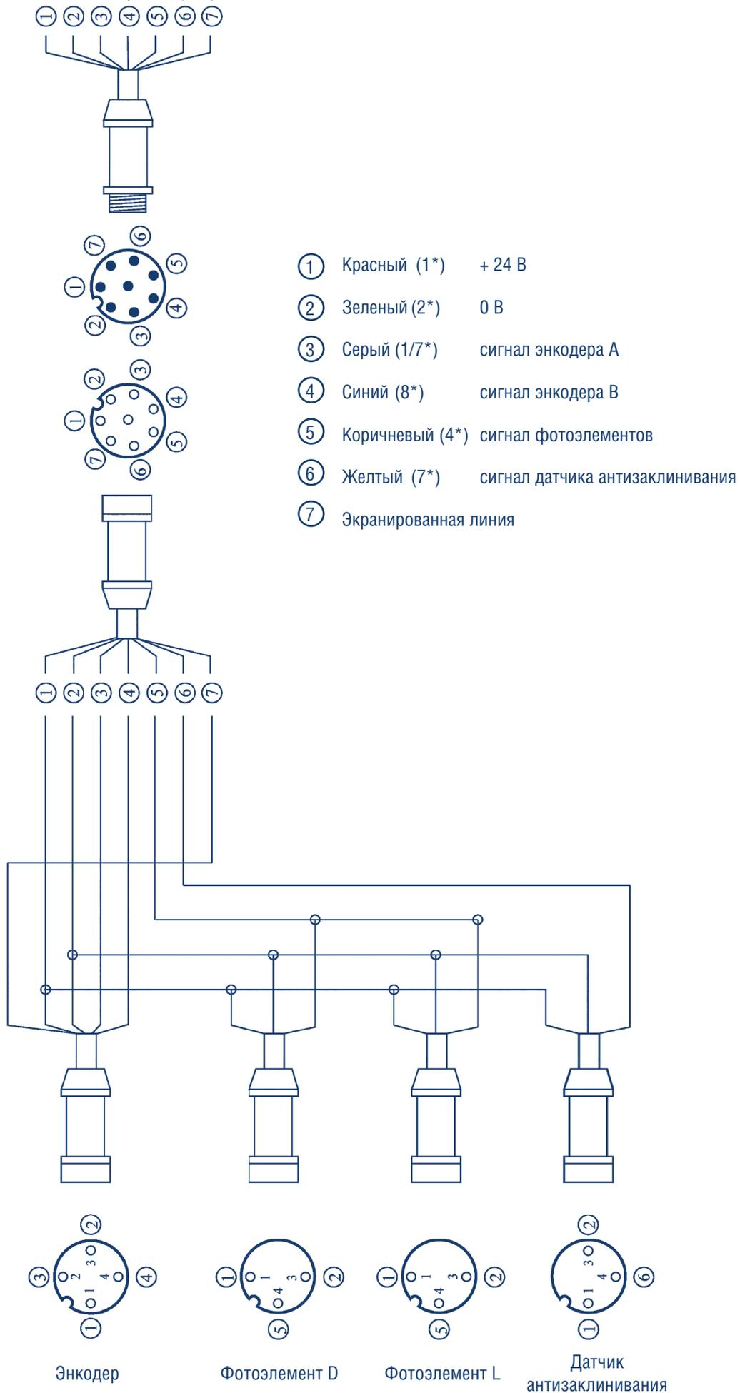
\* Провода кабеля «спайдер» арт. HSD 1842 выполнены в черном цвете и пронумерованы.
