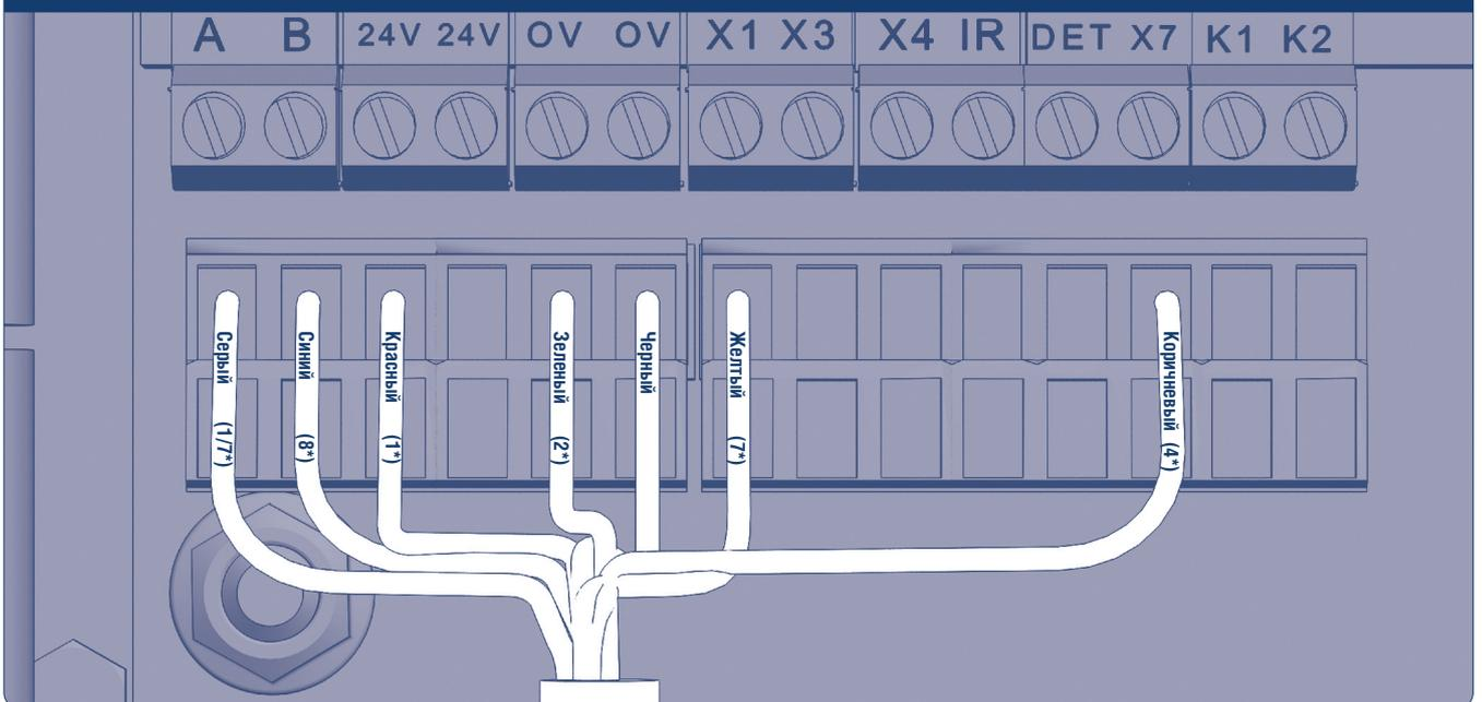
\* Провода кабеля «спайдер» арт. HSD 1842 выполнены в черном цвете и пронумерованы.
