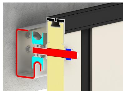
Верхний стальной ролик полотна ворот имеет улучшенные прочностные характеристики, что продлевает рабочий ресурс ворот.
